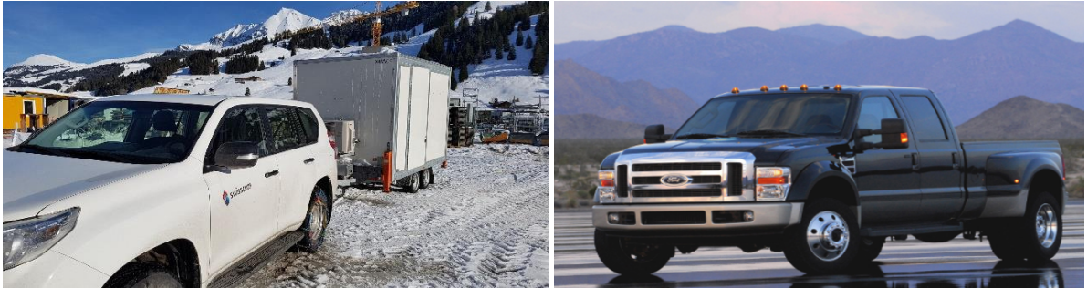
Abbildung 10: Typische Zugfahrzeuge für kleinere (links) und grössere Diesel-Notstromaggregate (rechts).
